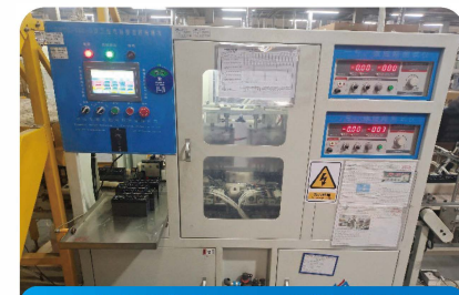
先进实验检测设备-极群短路检测
