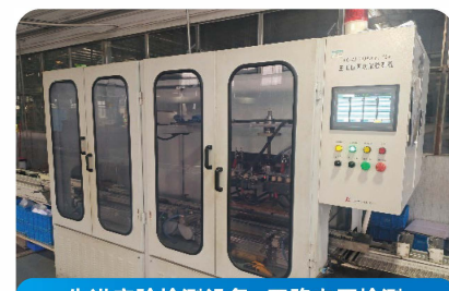
先进实验检测设备-开路电压检测
