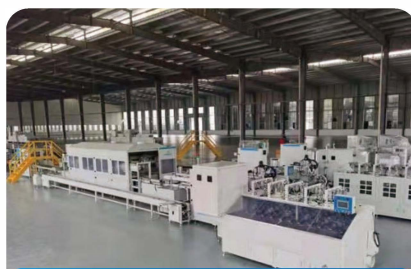
组装车间-小密全自动铸焊生产线
