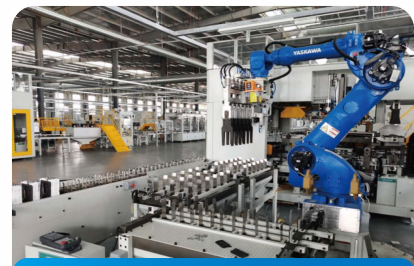
组装车间-中密全自动铸焊生产线
