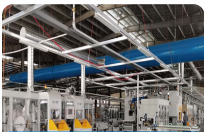
组装车间-中密全自动铸焊生产线
