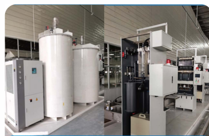
加酸车间-独立冷酸系统/智能真空加酸
