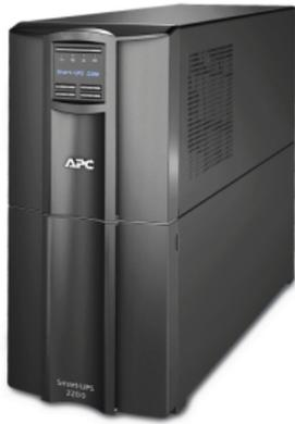
APC在线互动UPS, 2200VA,塔式标机, 230V,8个IEC C13, 1个IEC C19插座, 带智能插槽, 液晶显示
